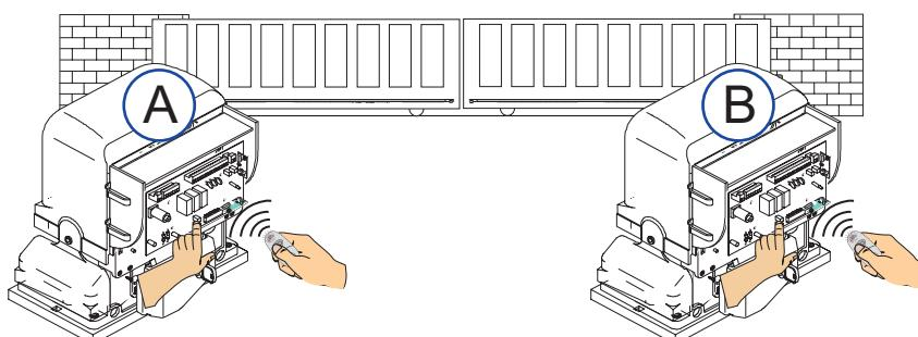
6) Для активации системы дистанционной разблокировки на обеих приводах, установить в каждый радиоприемник (разъем AF2). Выполнить запись кода системы “Pratico” на обоих блоках управления (раздел 8, стр. 14).
