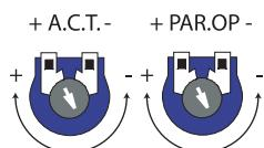
Регулировка А.С.Т. = Время автоматического закрытия. По истечении установленного времени ворота закроются автоматически. Время регулируется от 1 до 120 с.
