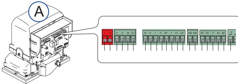
2) Выполнить электрические подключения блока управления привода А (см. раздел 6.3 “Электрические подключения”)
