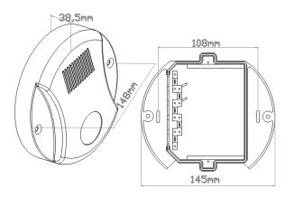
Блок управления SAT SWR – устройство, созданное для защиты от ветра, измерения интенсивности дождя и светового излучения. Оно способно управлять одним, двумя или более приводами/радиоприемниками SAT IS.
